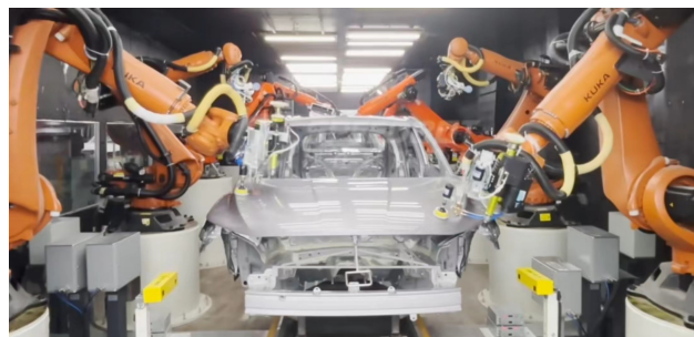
图 19 实时调整打磨工艺参数以提升材料去除精度
